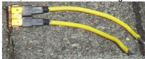
Abbildung 17: BC Stromversorgung Billiglösung
