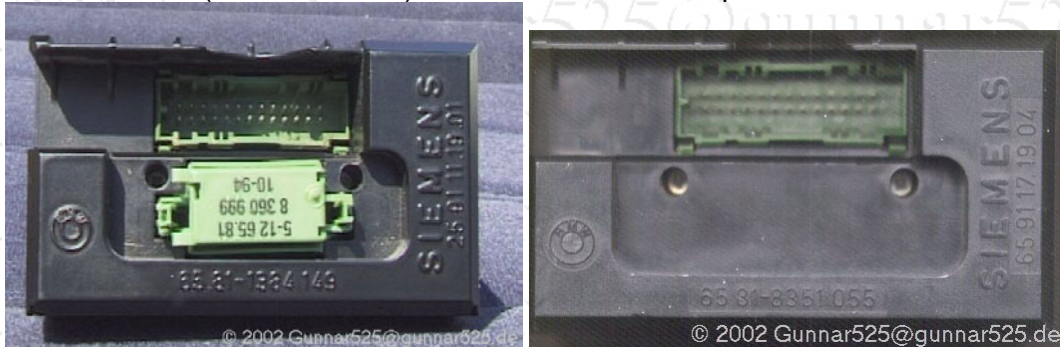
Abbildung 11: BC IV mit und ohne Codierstecker
