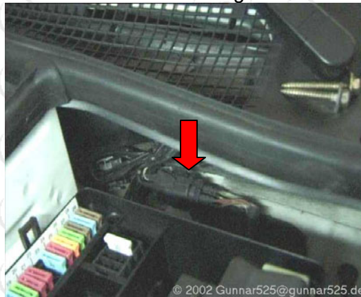
Abbildung 21: Vorverkabelung DWA-Horn und Motorraumkontaktschalter
