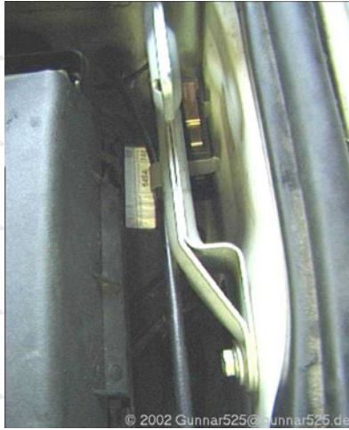
Abbildung 25: Der eingebaute Kontaktschalter
