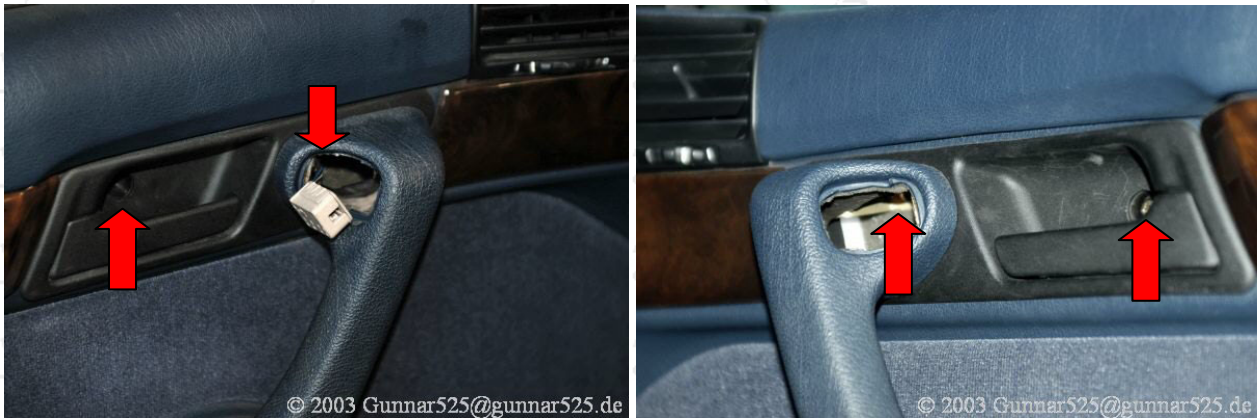
Abbildung 1: Schrauben der vorderen Türverkleidungen
