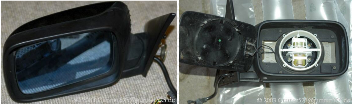
Abbildung 11: Ausbau des Spiegelglases
