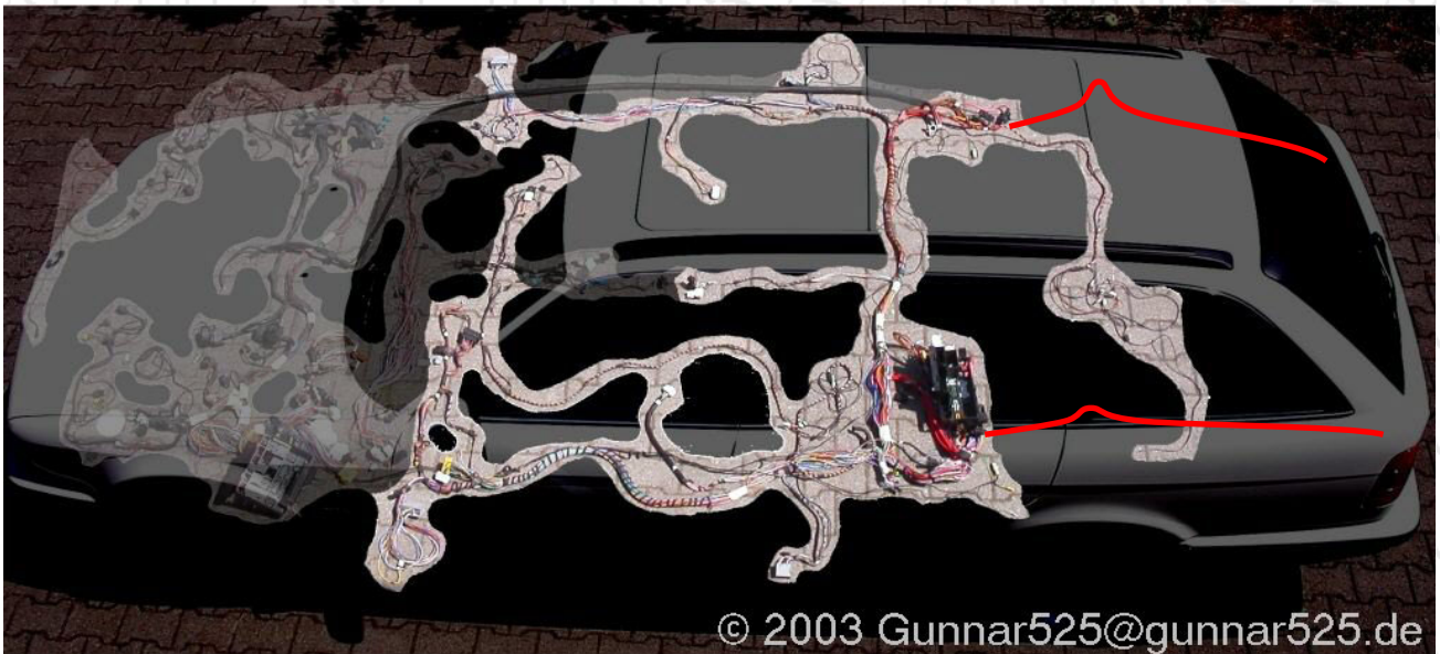
Abbildung 6: Lage hinterer Hauptkabelbaums
