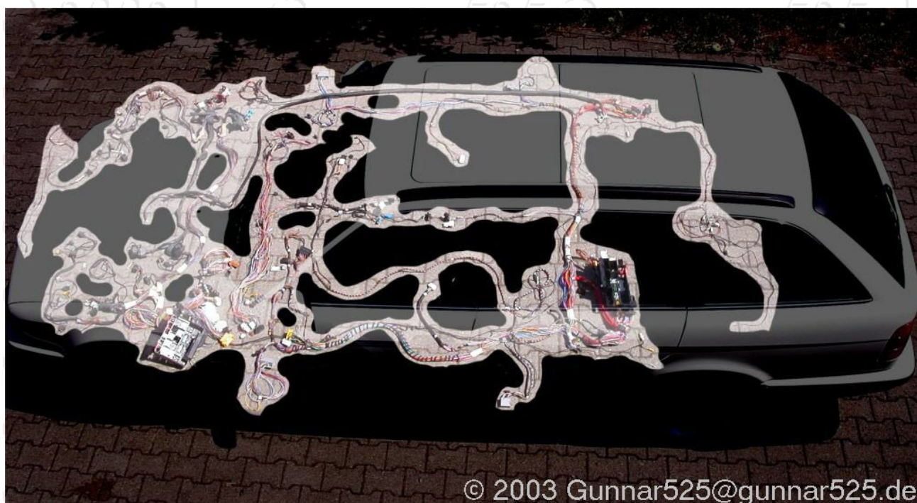
Abbildung 1: Übersicht der Kabelbäume
