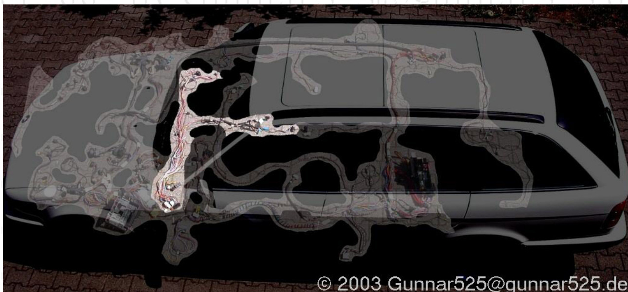
Abbildung 4: Lage mittleren Hauptkabelbaums
