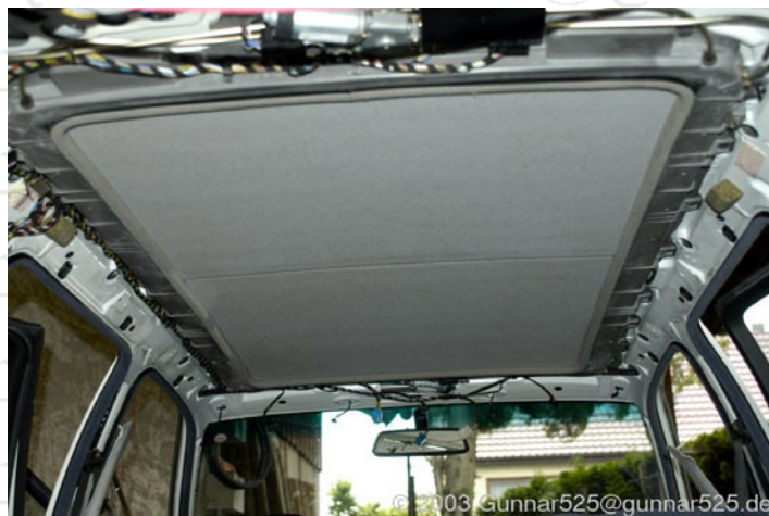
Abbildung 7: Kabelführung im Dach
