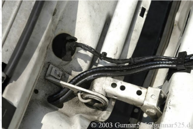
Abbildung 4: Schlauchdurchführung am Scharnier
