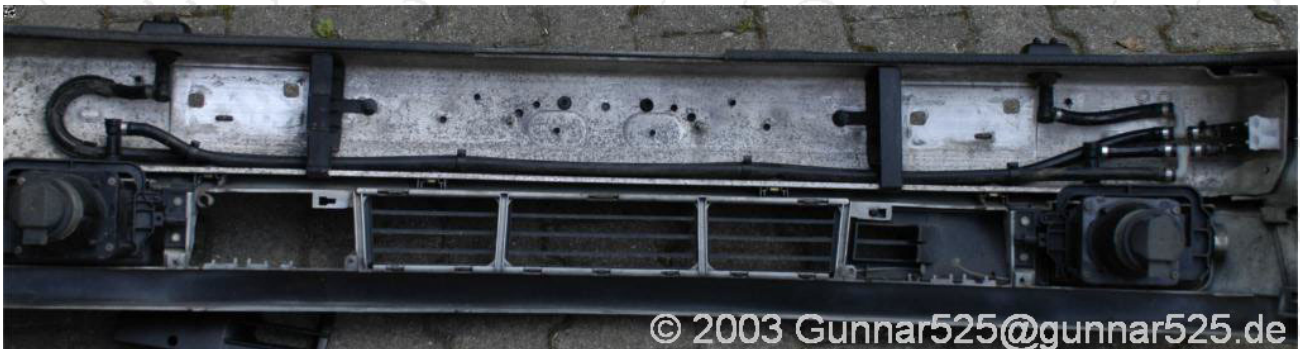
Abbildung 6: Verlegen der Schlauchleitungen
